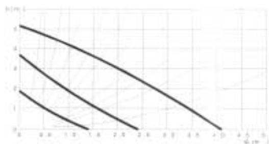
В в/у диаграмме указанное давление (или высота поднимания воды) можно составить в области стоимости самого низкого уровня до стоимости кривых убытков газовых котлов termet s.a. „Технические данные” включают гидравлические убытки воды при повышению её температуры о 20 °С.
