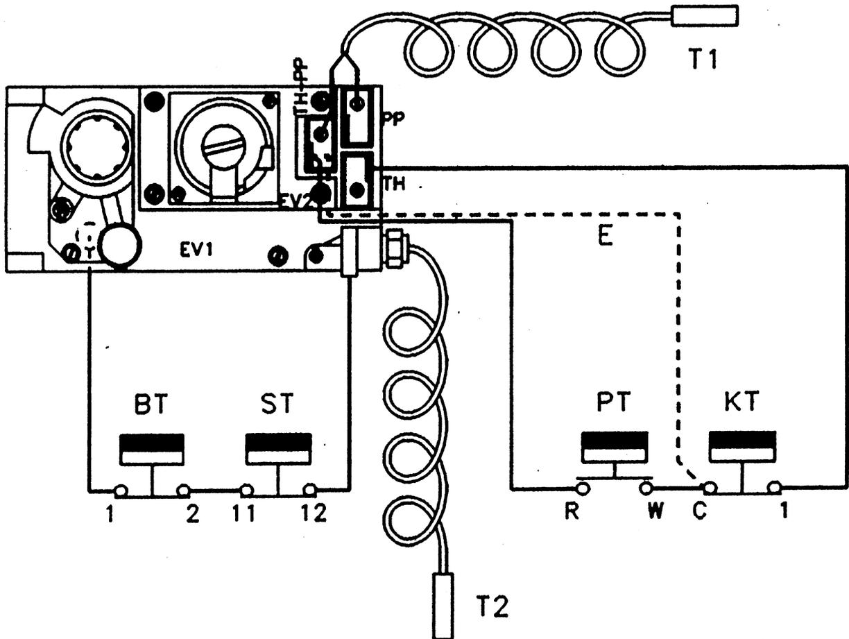
**EV1-** газовый клапан с оператором для mV VS 8620 C 1003
